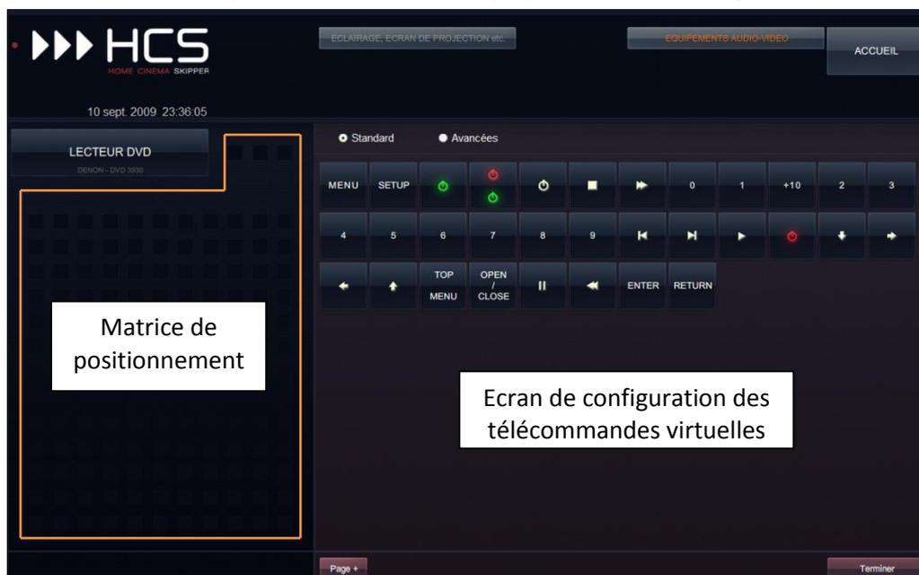
L'écran de configuration propose les boutons compatibles avec la télécommande virtuelle en cours de configuration.
